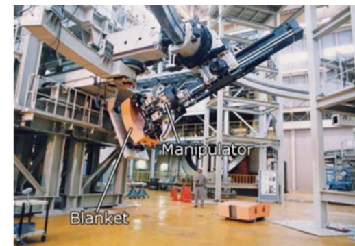
Mock-up Blanket RH System IVT – JA DA
